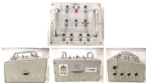
Fig. 4. Caixa de controle utilizada na interface entre a plataforma experimental e os sistemas de solo.
